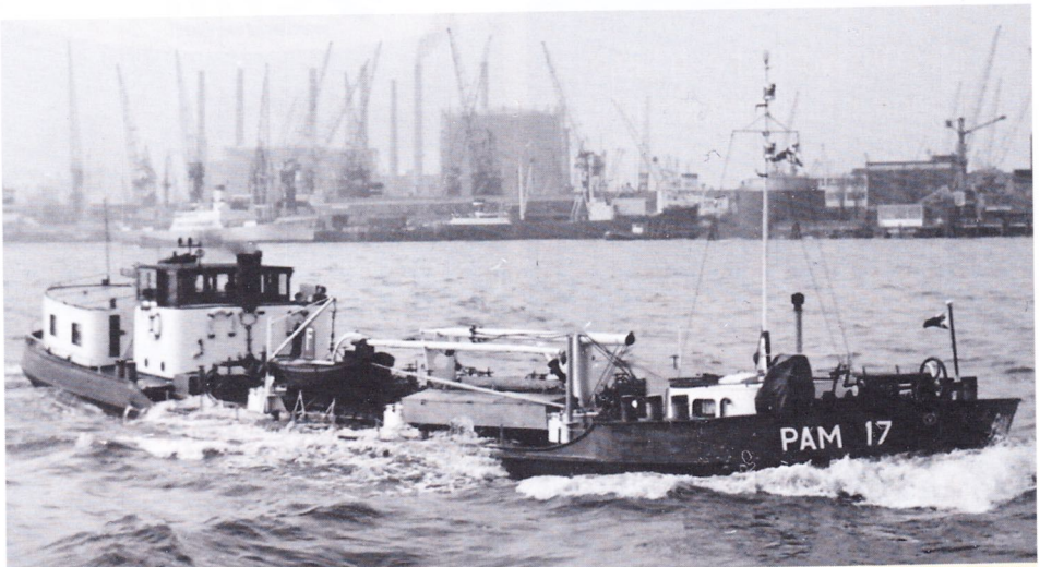
TOILER 7 (2308586 – 39,97 x 6,58 x 2,12 - 287 ton – 200 pk Bolnes). In 1951 gebouwd bij Timmer in Overschie als mts TOILER 7. In 1957 herdoopt in PAM 17. Later verlengd tot 49,96 m – 411 ton – 240 pk Scania Vabis. In 1970 herdoopt in CALPAM 17. In 1981 verkocht aan Tankercleaning BV in Rotterdam en herdoopt in Steven Langeberg. Na een stranding in 1993 verkocht voor de sloop. Door de sloperij weer doorverkocht en in 1995 in de vaart gebracht als SIM van Sim Scheepvaart NV in Rotterdam. In 1999 gesloopt.
