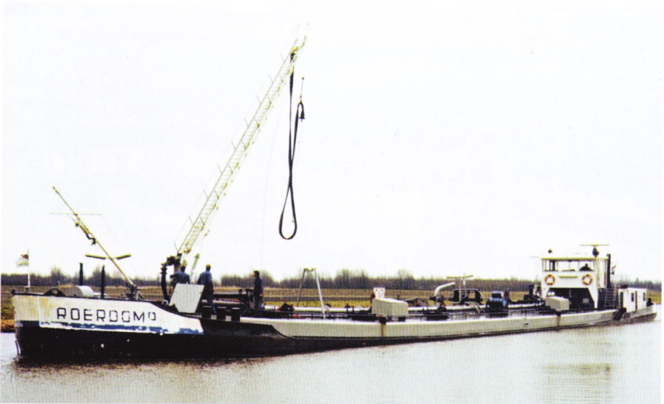
ROERDOMP (3011783 – 77,20 x 8,22 x 2,62 – 1102 ton - 590 pk Crossley). In 1963 gebouwd bij de Ruhrorter Schiffswerft, Duisburg als ROERDOMP voor de Firma Roerdomp in Den Haag. In 1970 overgenomen door Calpam Nederland NV in Utrecht. In 1981 overgenomen door Nedlloyd Rijn & Binnenvaart BV in Rotterdam en herdoopt in NEDLLOYD 26. Nieuwe motor: 810 pk Cummins. In 1982 verkocht en vervolgens gevaren onder de namen: MYRA – ROSA (1982) – EXCALIBER (1984) – ANDRA (1984) – KARBOUW (1986) – TITANIC (1998) – CHARLES D. Sinds 2010 in de vaart als BIZET van ARA Bunker Supply bvba in Antwerpen.
