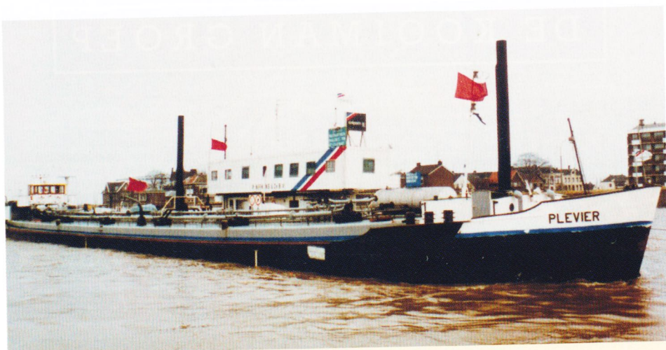
LIJTO 5 (2311107 – 77,08 x 8,24 x 2,59 – 1078 ton – 500 pk Deutz). In 1961 bij de Meidricher Schiffswerft in Duisburg gebouwd als LIJTO 5. In 1970 herdoopt in PLEVIER. In 1981 overgenomen door Nedlloyd Rijn & Binnenvaart BV in Rotterdam en herdoopt in NEDLLOYD 17. Nieuwe motor: 973 pk Caterpillar. Vervolgens gevaren onder de namen: RUSTY (1982) – CHRILEJO (1983) – IZABEL (1983) – ANITA (1988) – HILDEGARD (1992) – EIBEL EXPRESS (1999) – AVIA EXPRESS (2010) – ARIES (2013).
